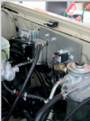
**Nachgerüstete Kommandobrücke:** Im Motorraum ist seitlich das von der SK Handels AG entwickelte Steuergerät angebracht. Zusammen mit den verbauten Sensoren entlang der Auspuffanlage wird gemessen, welche Menge an AdBlue-Additiven eingespritzt werden muss, um die Abgaswerte zu verbessern.
