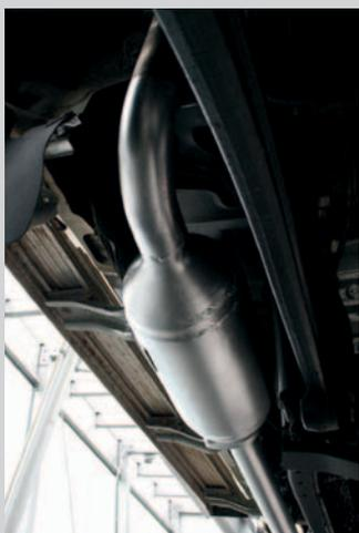
**Gut geschützt:** Der Katalysator ist zwischen Motor und Partikelfilter verbaut und am Rahmen angebracht.
