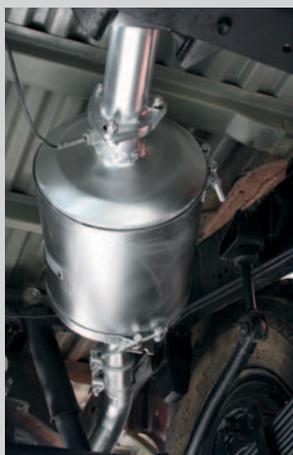
**Stets mobil:** Der SCR-Filter mit integriertem Rußpartikelfilter kann im Notfall problemlos ausgetauscht werden.
