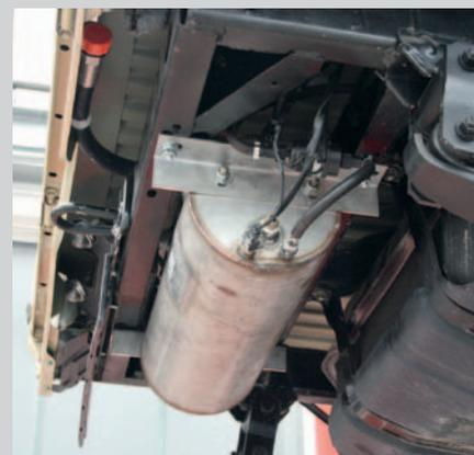
**Zusatztank:** Der Behälter für das AdBlue-Additiv ist so geschickt am Heck des HZJ angebracht, dass die Geländegängigkeit des Toyota nicht darunter leidet. Zudem wird der Behälter später noch von einer Platte vor Umwelteinflüssen geschützt.
