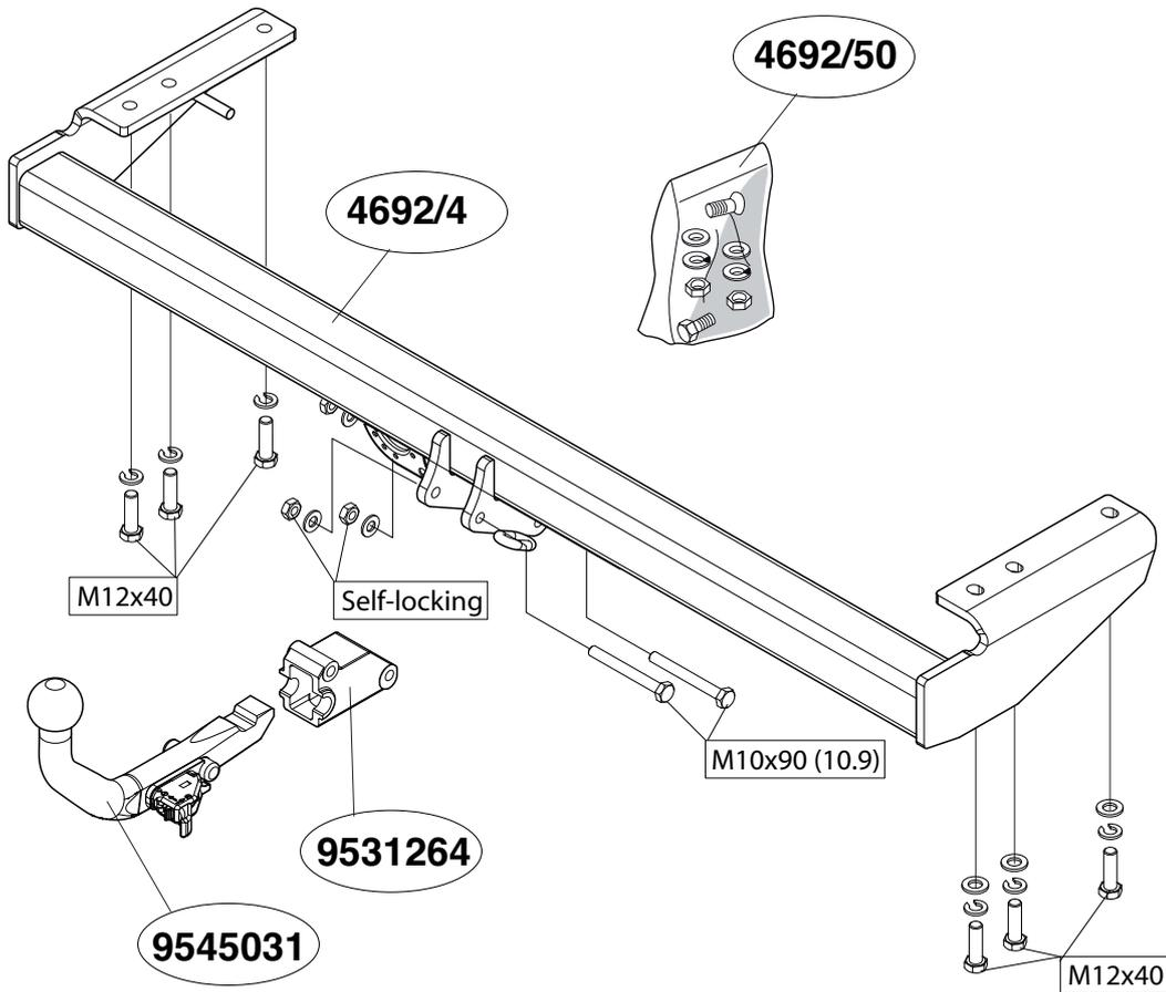
1. Maak de bodenvloer in de bagageruimte vrij. Verwijder de zijpanelen en de accu-beschermbak. Neem de bevestiging van de accu los. Maak indien aanwezig de connector los, welke aan de rechterkant in de bagageruimte in de bumper zit. Zie fig. 1. Demonteer de bumper d.m.v. het verwijderen van vier bouten in de bagageruimte. Zie fig. 1. Boor vervolgens t.p.v. de onderkant van de wielkastranden twee popnagels d.m.v. een  $\varnothing$  6 mm. boor uit. Zie fig. 2.
