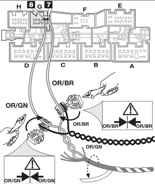
Bordnetzsteuergerät Position "G"
