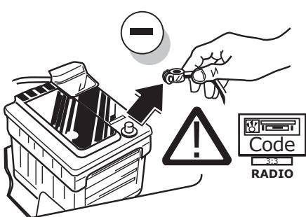
(DE) Um Störungen und Schäden am Bordnetz zu vermeiden, muss die Massepolklemme unbedingt vor Beginn aller Arbeiten von der Fahrzeughinterseite getrennt werden! Insbesondere bei Arbeiten und Anschlüssen am CAN-Datenbus kann bei nicht abgeklemmter Batterie sowohl das Anhängermodul als auch das fahrzeugeigene Bordnetzsteuergerät beschädigt werden! Bitte Herstellervorschriften beim Ab- und Anklemmen der Fahrzeughinterseite beachten!
