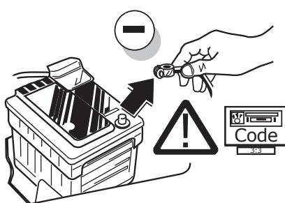
(DE) Um Störungen und Schäden am Bordnetz zu vermeiden, muss die Massepolklemme unbedingt vor Beginn aller Arbeiten von der Fahrzeugbatterie getrennt werden! Insbesondere bei Arbeiten und Anschlüssen am CAN-Datenbus kann bei nicht abgeklemmter Batterie sowohl das Anhängermodul als auch das fahrzeugseitige Bordnetzsteuergerät beschädigt werden! Bitte Herstellervorschriften beim Ab- und Anklemmen der Fahrzeugbatterie beachten!
