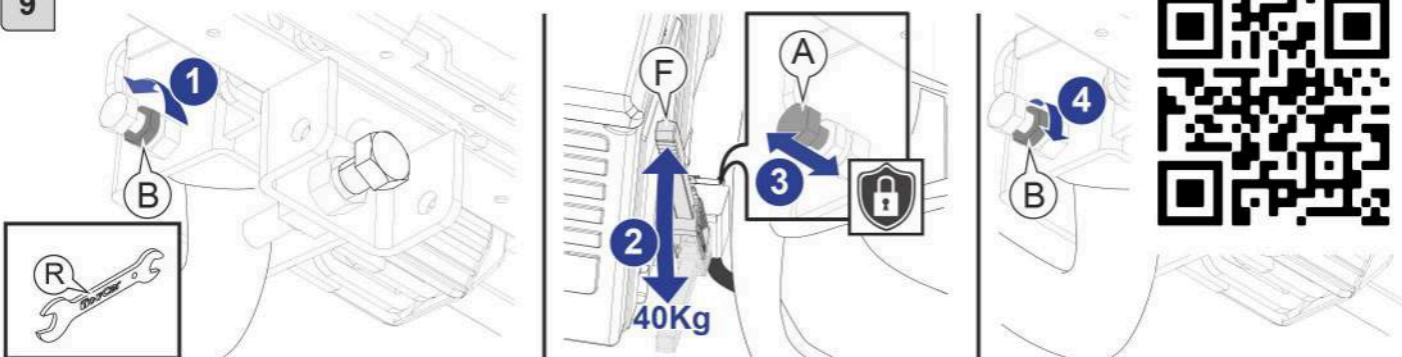
**ES** Ajuste del cabezal: Afloje la contratuerca (B), apriete el tornillo (A) hasta que el cabezal no pueda girar (en caso de que no sea posible bajar la palanca con la fuerza de la mano, afloje un poco el tornillo) tiene que ajustarse de tal manera que se necesiten alrededor de 40 kg de fuerza manual. Una vez se consiga un buen ajuste, apriete la contratuerca (B). Esta operación debe ser repetida cada vez que note que se disminuye la resistencia.
