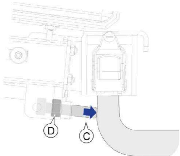
**ES** Ajuste del sistema antibalanceo: Afloje la contratuerca (D) y gire el tornillo (C) hasta que haga contacto con el cuello de la bola del enganche. Vuelva a apretar la contratuerca (D). Esta operación se realizará solo la primera vez que coloquemos nuestro TowBox en el vehículo o si lo colocamos sobre un vehículo diferente al nuestro.
