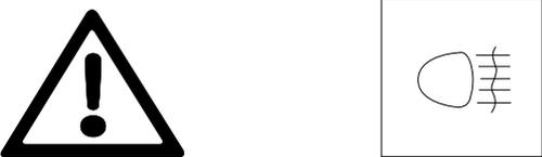
**D** Wenn die Nebelschlussleuchte am Fahrzeug eingeschaltet ist, darf der Anhänger nicht an -oder abgekuppelt werden!
