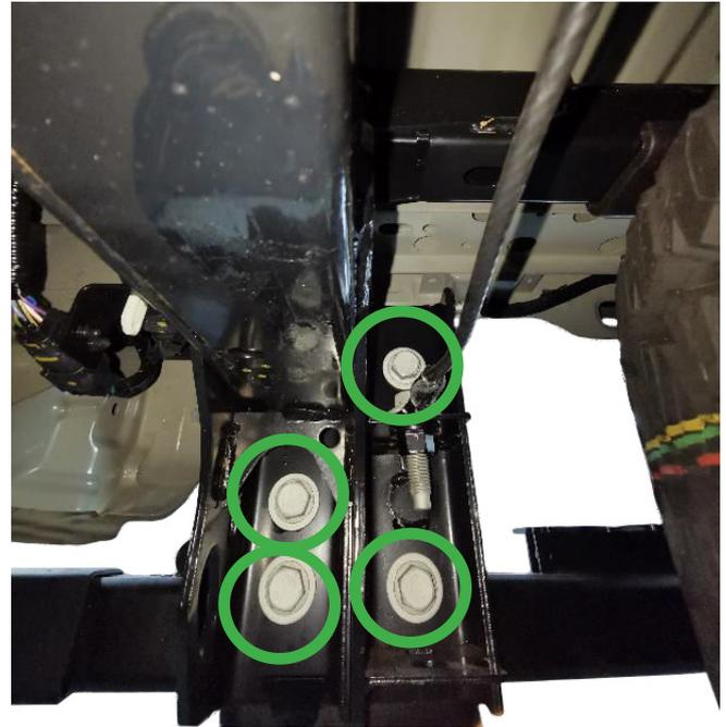
7. Achten Sie darauf, dass der Querträger abgestützt wird (z.B. mit einem Getriebeheber) und mindestens eine weitere Person Ihnen bei der Demontage behilflich ist.
