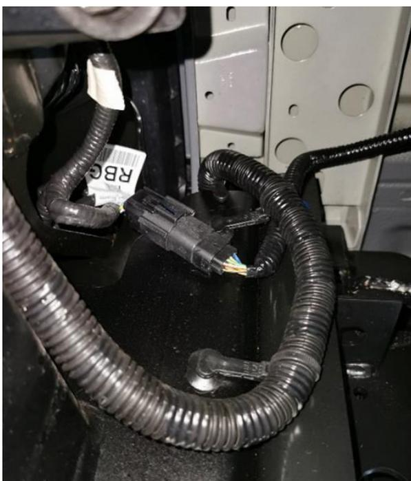
**2. Trennen Sie nun die Steckverbindung des hinteren Stoßfängers vom Kabelbaum.**
