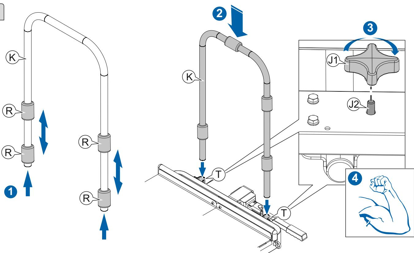
**ES** Deslizar los cuatro protectores de espuma (R) por la barra (K) y posicionarlos en aquellos puntos del carenado o cuerpo de la moto que puedan entrar en contacto con el tubo. Introducir el soporte en las abrazaderas (T) y apretar con fuerza el volante (J1). Verifique su correcta fijación.
