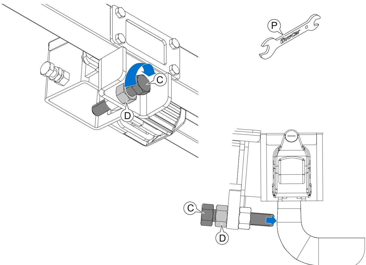
**ES** Ajuste del sistema antibalanceo: Afloje la contratuerca (D) y gire el tornillo (C) hasta que haga contacto con el cuello de la bola del enganche. Vuelva a apretar la contratuerca (D). Esta operación se realizará solo la primera vez que coloquemos nuestro portamotos en el vehículo o si lo colocamos sobre un vehículo diferente al nuestro.
