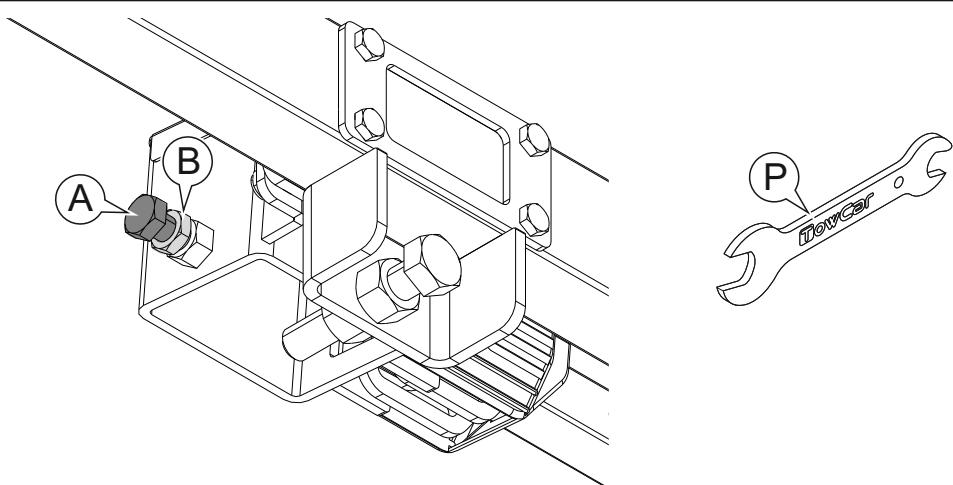
**ES** Ajuste del cabezal: Afloje la contratuerca (B), apriete el tornillo (A) hasta que el cabezal no pueda girar (en caso de que no sea posible bajar la palanca con la fuerza de la mano, afloje un poco el tornillo). Una vez se consiga un buen ajuste, apriete la contratuerca (B). Esta operación debe ser repetida cada cierto tiempo.
