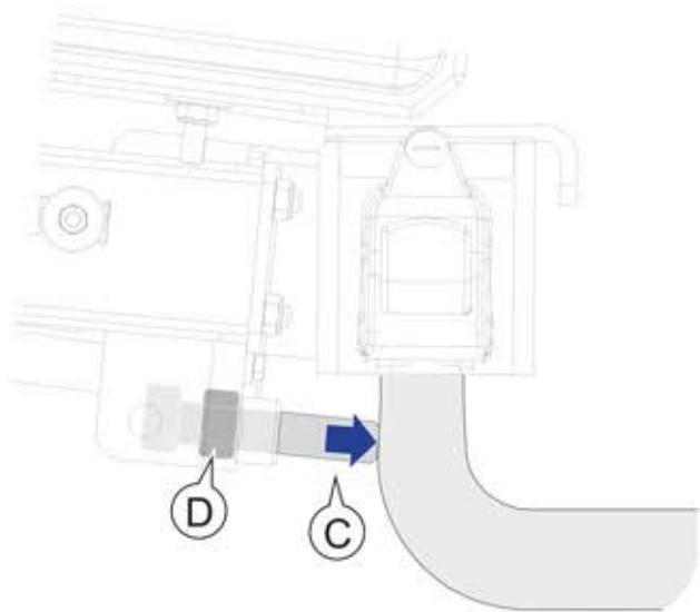
**ES** Ajuste del sistema antibalancio: Afloje la contratuerca (D) y gire el tornillo (C) hasta que haga contacto con el cuello de la bola del enganche. Vuelva a apretar la contratuerca (D). Esta operación se realizará solo la primera vez que coloquemos nuestro TowBox en el vehículo o si lo colocamos sobre un vehículo diferente al nuestro.
