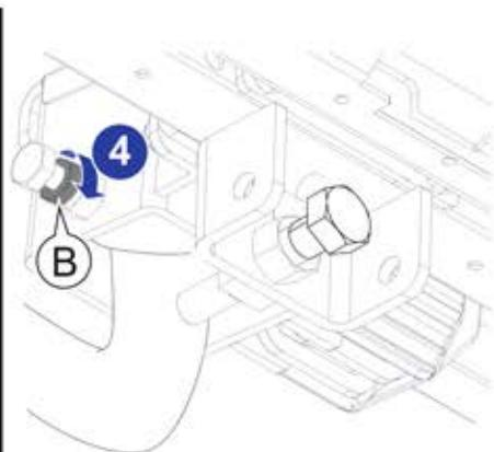
**ES** Ajuste del cabezal: Afloje la contratuerca (B), apriete el tornillo (A) hasta que el cabezal no pueda girar (en caso de que no sea posible bajar la palanca con la fuerza de la mano, afloje un poco el tornillo). Una vez se consiga un buen ajuste, apriete la contratuerca (B). Esta operación debe ser repetida cada cierto tiempo.
